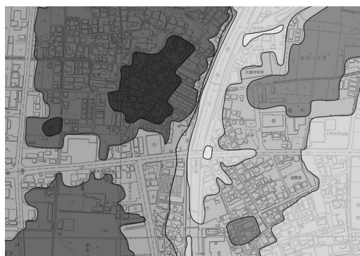
図1：1/2500地形図に等高線の補助線を引き、色分けした地図。色が濃い方の標高が低く、薄い方の標高が高い。図の左上部分の一番標高が低く、この地図の範囲では浸水の可能性が一番高いことがわかる。1/2500地形図「門真市全図6」（昭和50年測量）を使用（ただし表示地域は大東市）。
