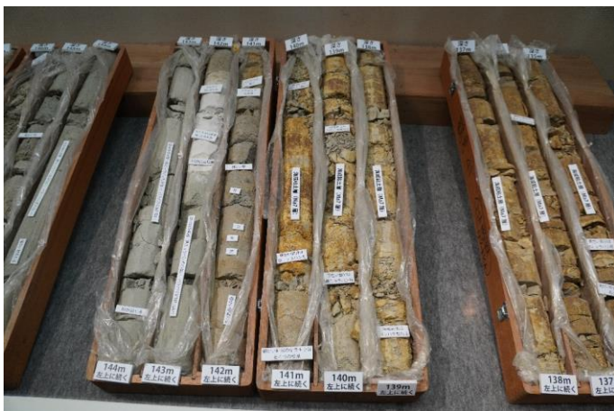
1. 大阪市内で採取された活断層調査のボーリングコア（第51回特別展の展示の様子）
